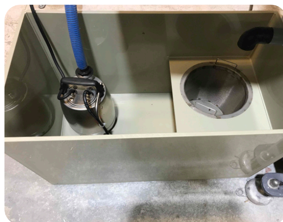
90 L. Buffertank med filterkurv og dykpumpe
