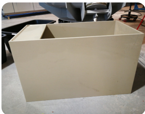
90 L. Buffertank med filterkurv og dykpumpe
